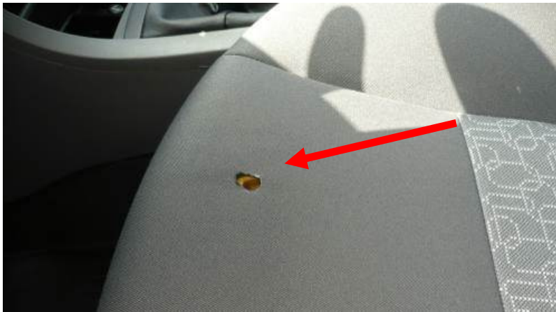
Cigarettaparázs által kitégetett üléskárpit, mely előfordulhat a hátsó üléseken is. Seat trim damaged by cigarette burn, which may also occur on the back seats.
